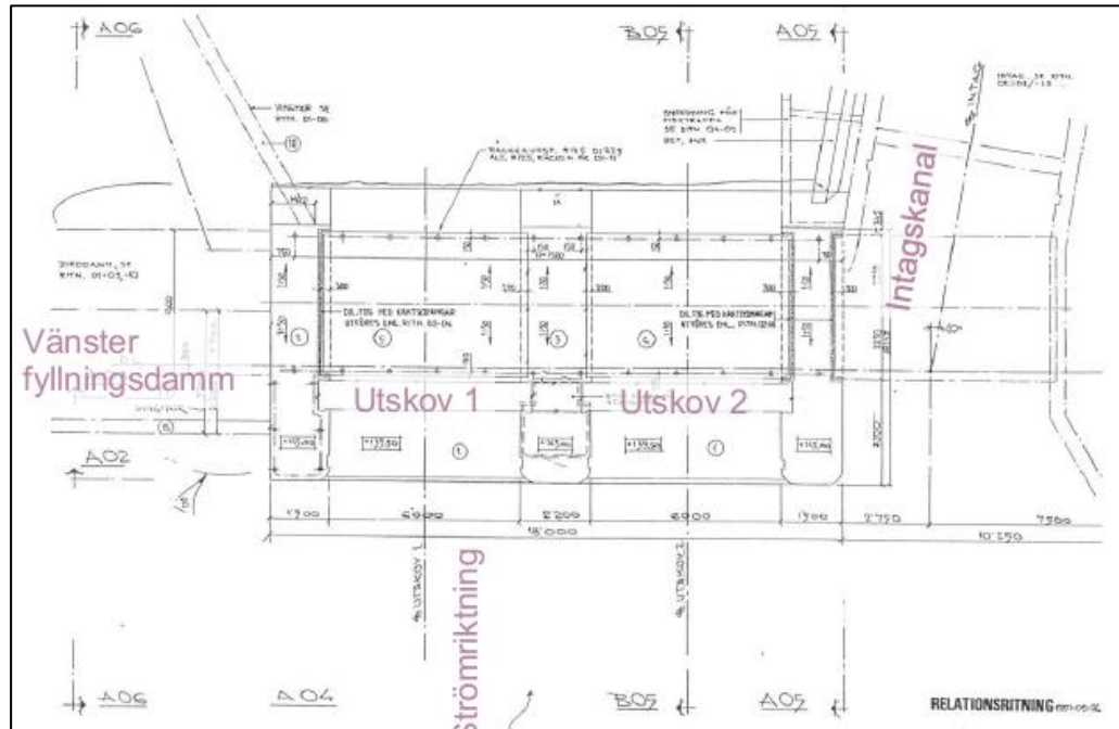
Figur 2. Hednäs kraftverk, regleringsdammens utskov och brobana i plan. Från ritning 01-04, VBB 1997.
