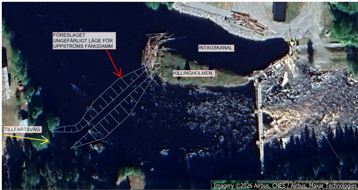
Figur 11 - Föreslagen placering för uppströms fångdamm
