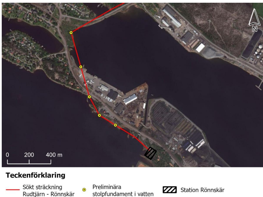
Figur 3 Preliminär placering av de stolpfundament som planeras anläggas i vattenområde.
