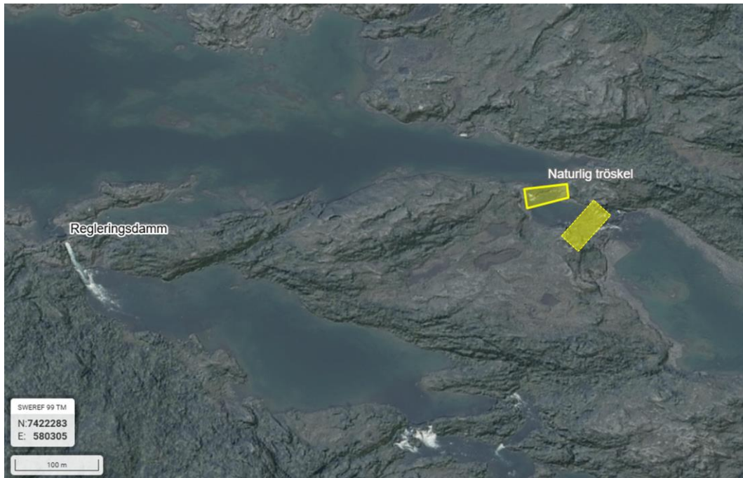
Figur 22. Gulmarkerat område med heldragen linje visar den ungefärliga platsen för de planerade åtgärderna. Vid den naturliga tröskeln skapas en djupränna med kontinuerligt vattenflöde. Det gulmarkerade området med streckad linje visar nästa tröskel som eventuellt behöver åtgärdas, men där kompletterande mättningsarbeten erfordras.
