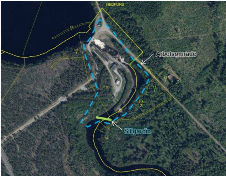
Figur 25 Utplacering av siltgardin nedströms Hednäs kraftverk för att minimera risken för grumling
