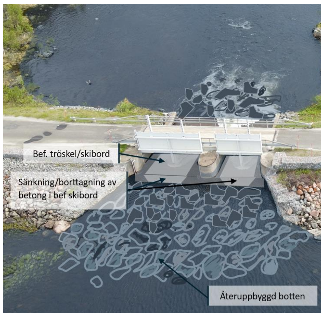
Figur 15. Princip för modifiering av befintliga betongbottnar samt principskissad utformning av återställda bottenområden vid utskoven.
