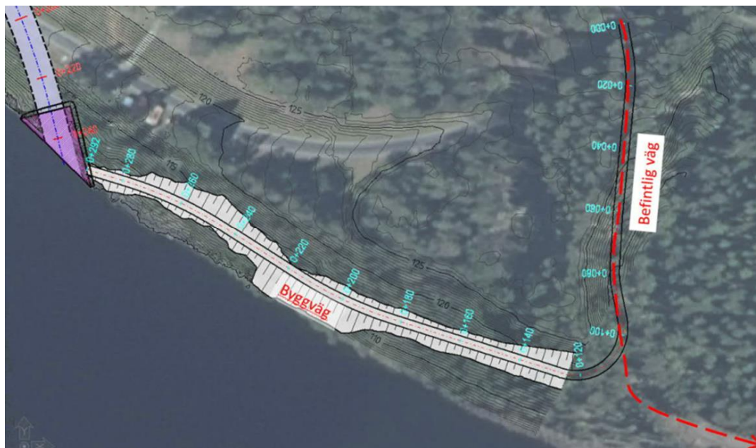
Figur 6. Arbetsväg under arbetstiden för att möjliggöra åtkomst vid nedströms tunnelmynning.
