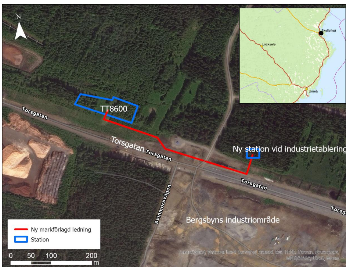
Figur 1. Karta med den planerade markförlagda 36 kV-ledningen.
