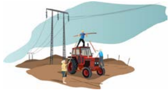
Bild 31 - Parkera inte fordon inom ledningens försiktighetszon.
