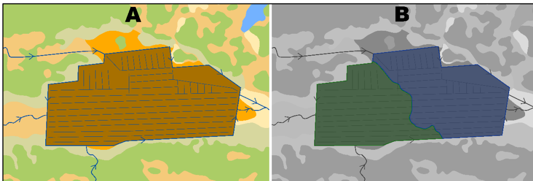
Figur 5. A visar en hypotetisk torvtäkt med diken och rinnriktningar. I B syns en bild av hur samma torvtäkt ser ut utifrån förmågan att producera skog (grön) och möjligheten av skapa våtmarker (blå). Fördelningen behöver inte alltid vara på det sätt som visas i illustrationen.
