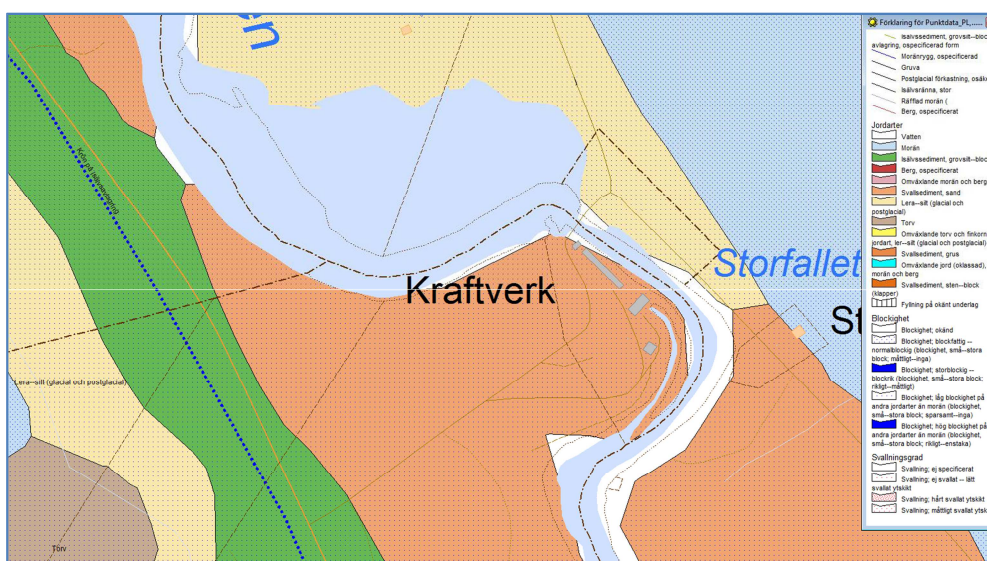
Figur 9. Hednäs kraftverk omges på höger strand av sandjord och på vänster strand av lerjord och längre från älven morän. Sanddominerad mark kan försvåra anläggningsåtgärder på höger strand pga. markstabilitet mm
